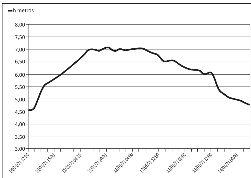
Figura 2. Limnigrama del río Ebro en El Bocal (Tudela) entre los días 9 y 13 de 1871.
