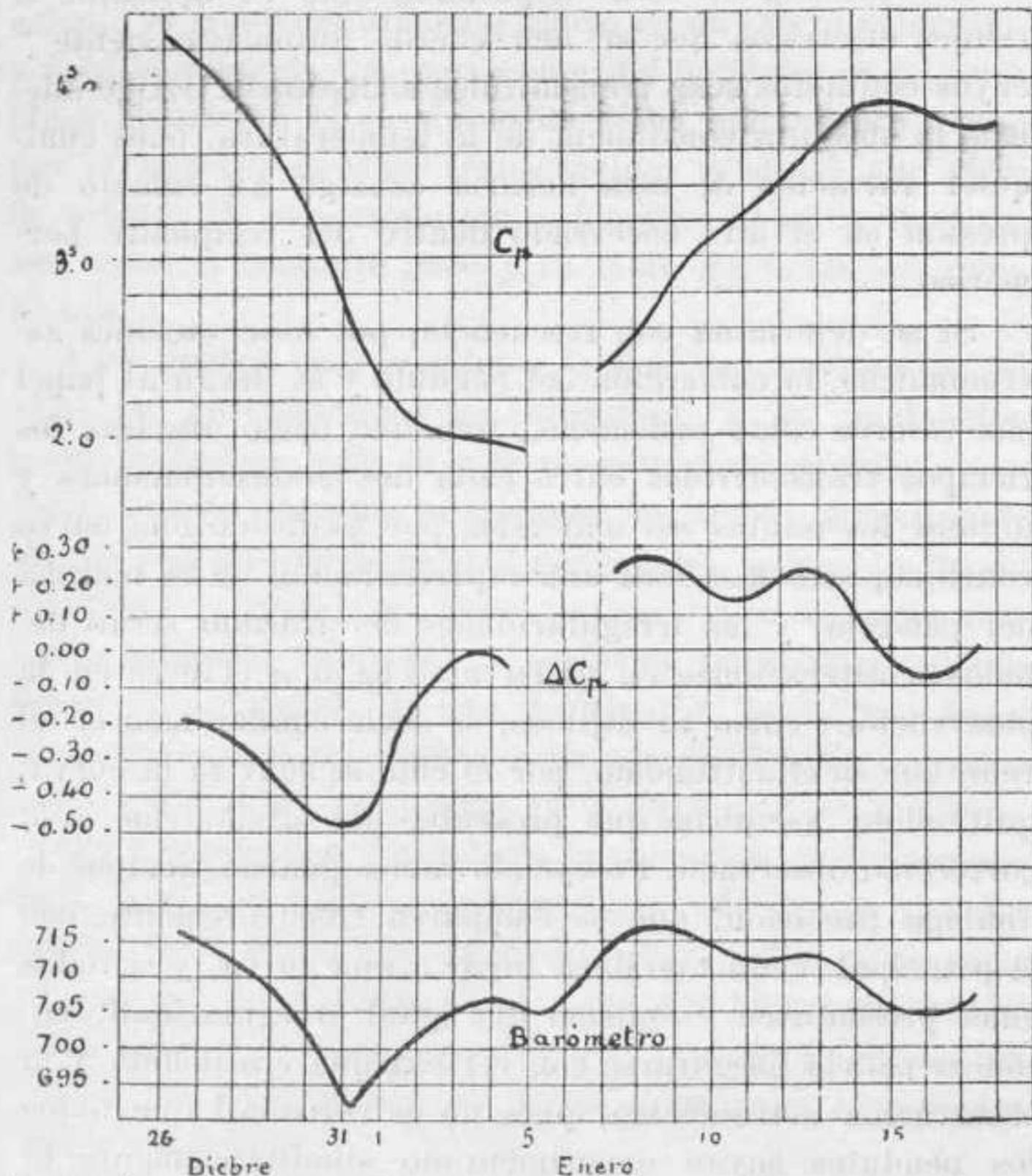
La curva de la parte superior está construida tomando como ordenadas los valores sucesivos de la corrección del péndulo  $C_p$ . De éstos se ha deducido la variación en 24 horas,  $\Delta C_p$  representada más abajo, y en la parte inferior se ha trazado la curva de la presión atmosférica, resultando las dos últimas casi paralelas, lo que pone de relieve la influencia de la presión sobre un péndulo al aire libre y sin compensación barométrica.
